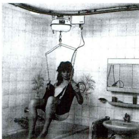
FIGURA 6. Sistema d'elevació i transport utilitzable per a l'accés al bany.
