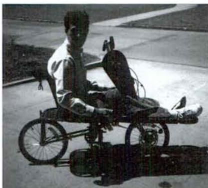
FIGURA 9. Bicicleta adaptada per a un paraplègic.
